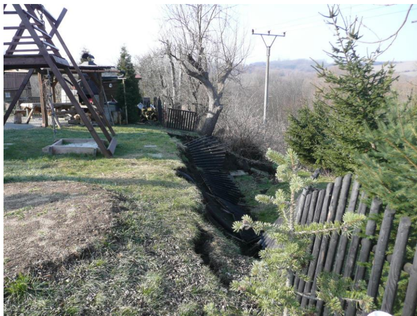
Foto 2: Východní sesuv – horní odlučná stěna s výškou skoku cca 1,5-2 metry
